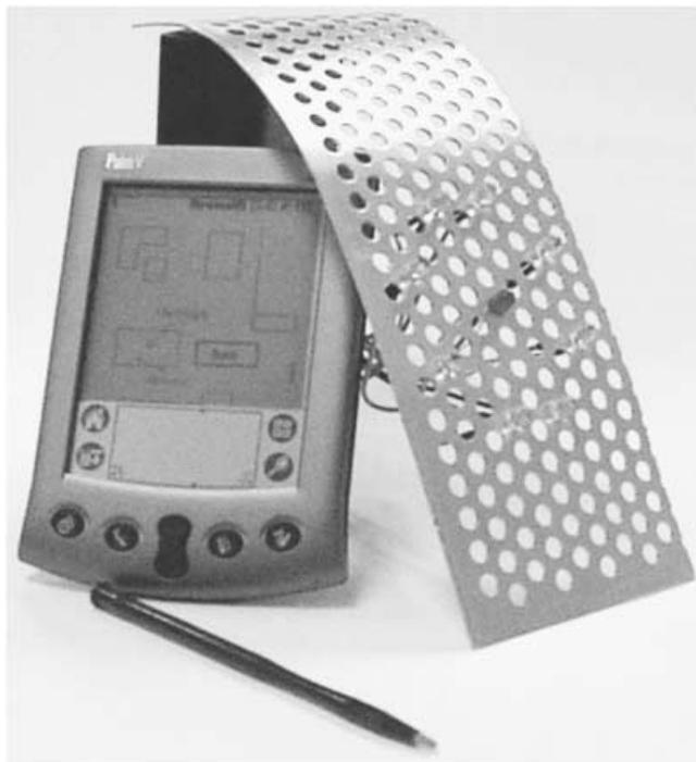
Abb. 2. Leistungsstarke Infrarotsender bilden die Grundlage des IRREAL-Systems
